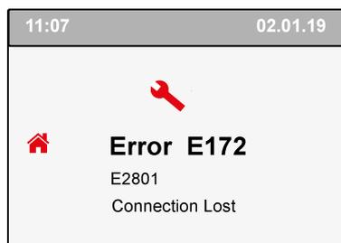
Fehlercode auf der Display Flair Gerät
