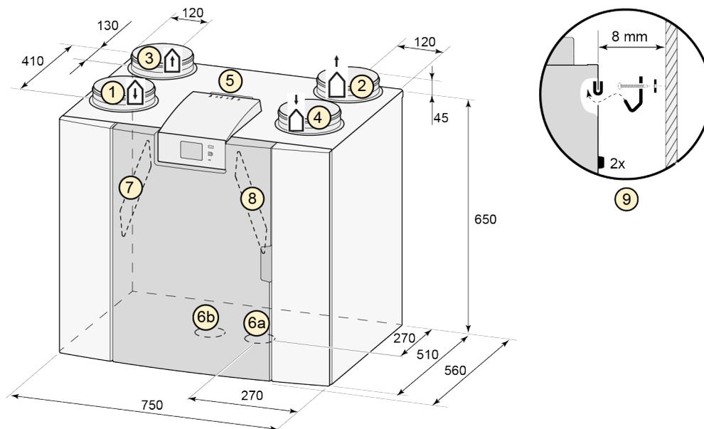
Alle Abmessungen sind in mm angegeben. Der Durchmesser sämtlicher Bundringe beträgt 160 mm.
