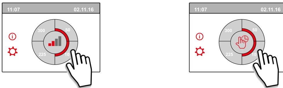
Durch Drücken eines der Viertelkreise im Hauptbildschirm kann der Belüftungsmodus auf schnelle Weise eingestellt werden.
