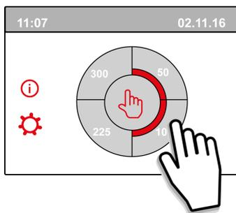
Der Touchscreen kann auch dauerhaft als Stufenschalter eingestellt werden; dazu muss Schrittnummer 15.8 im Einstellungs Menü auf „Ja“ gesetzt werden.
