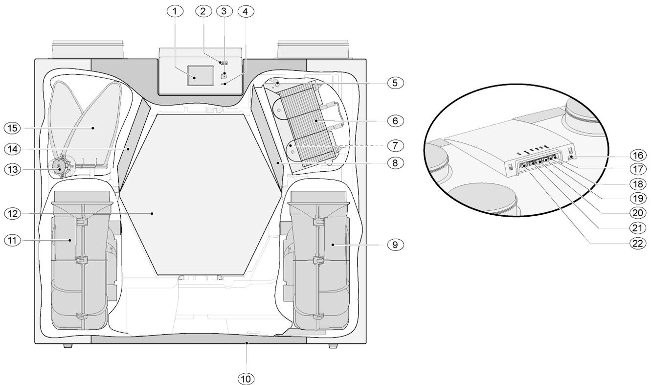
Das oben gezeigte Gerät ist eine Linksausführung; bei einer Rechtsausführung sind Vorheizregister und Bypassklappe gespiegelt montiert!
