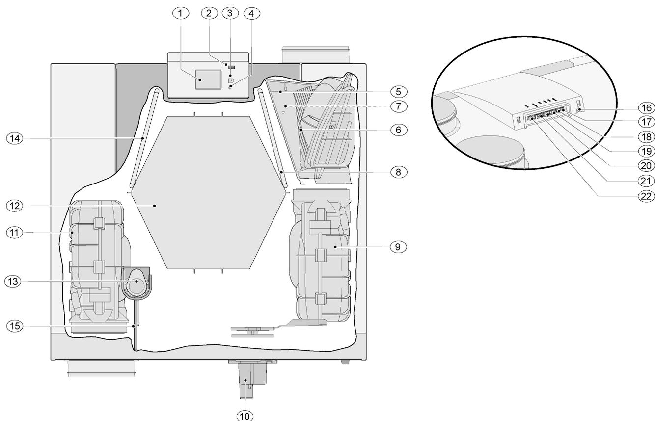
L'appareil illustré ci-dessus est une version gauche ; pour une version droite, le raccordement du préchauffage, la soupape de bypass et le raccordement du siphon sont installés en miroir !
