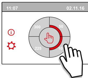
L'écran tactile peut également être défini en permanence comme interrupteur multiple; pour faire cette étape, le numéro 15.8 dans le menu des réglages doit être réglé sur «oui».
