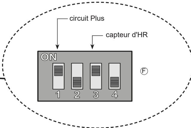
Si la sonde HR (capteur d'humidité relative) enregistre une augmentation du taux d'humidité ambiant pendant plusieurs minutes, le débit de ventilation sera automatiquement augmenté sur la position de ventilation 5.
