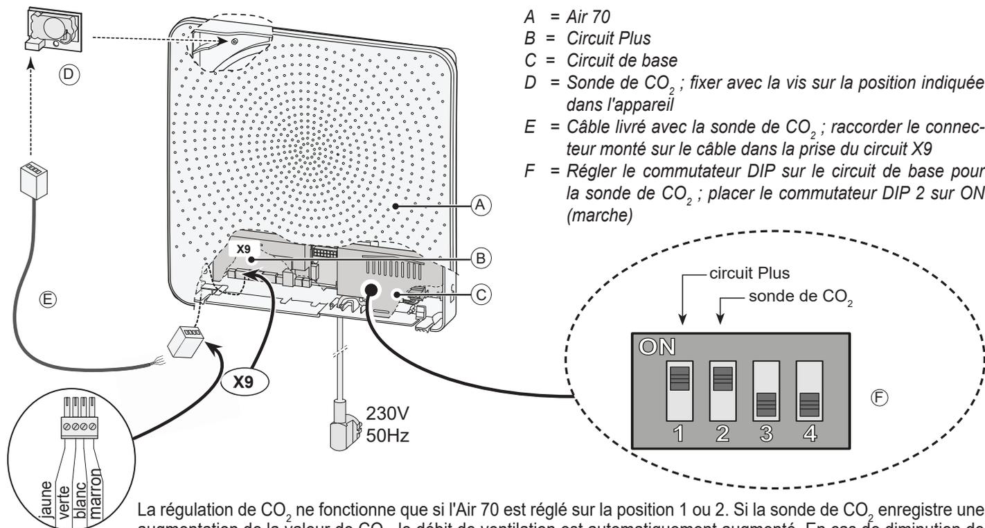
La régulation de CO<sub>2</sub> ne fonctionne que si l'Air 70 est réglé sur la position 1 ou 2. Si la sonde de CO<sub>2</sub> enregistre une augmentation de la valeur de CO<sub>2</sub>, le débit de ventilation est automatiquement augmenté. En cas de diminution de la valeur de CO<sub>2</sub>, le débit de ventilation est automatiquement diminué (voir illustrations).
