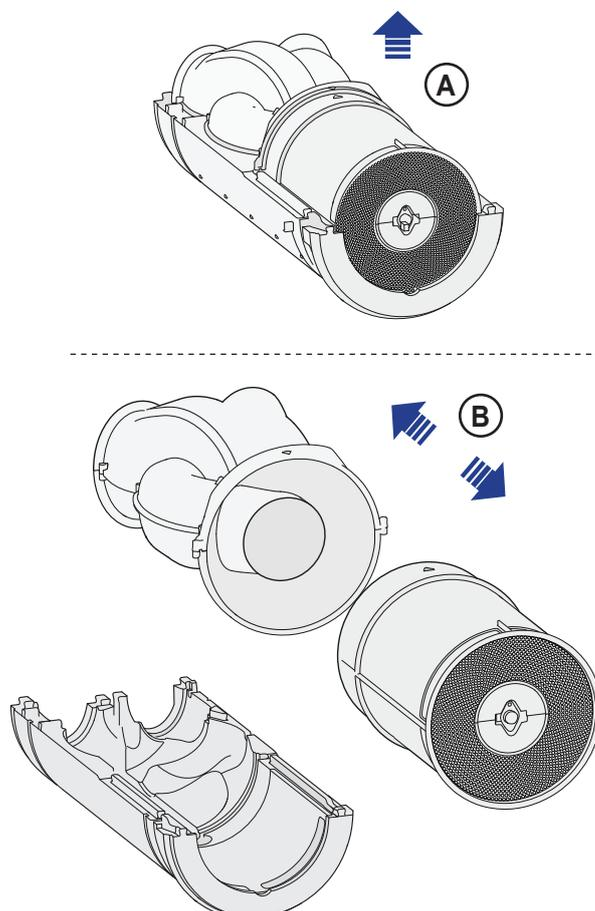
10 Nettoyer la partie ventilateur et l'échangeur de chaleur avec un aspirateur ou un pinceau souple.
