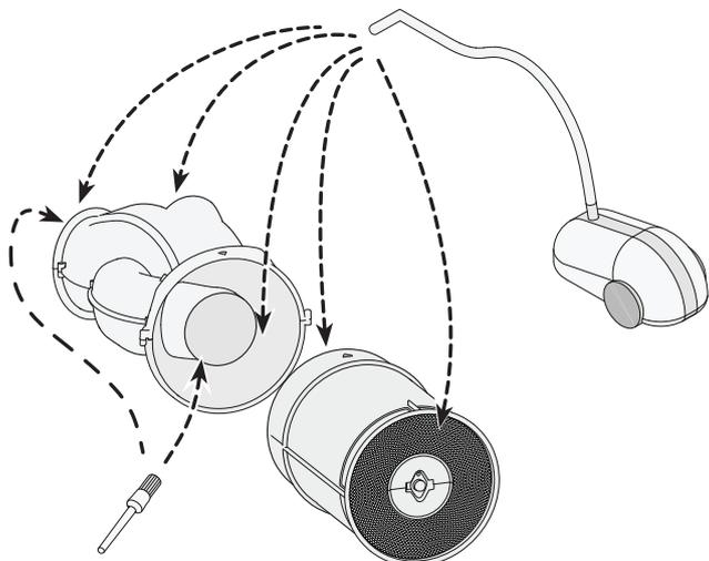
11 Nettoyage si possible l'intérieur de l'échangeur au jet pneumatique basse pression (max. 0,5 bar).
